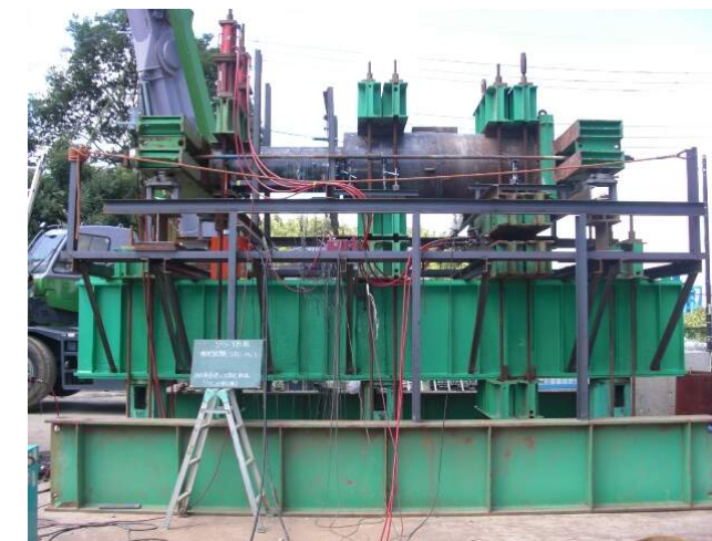
曲げ試験(載荷装置全景)
