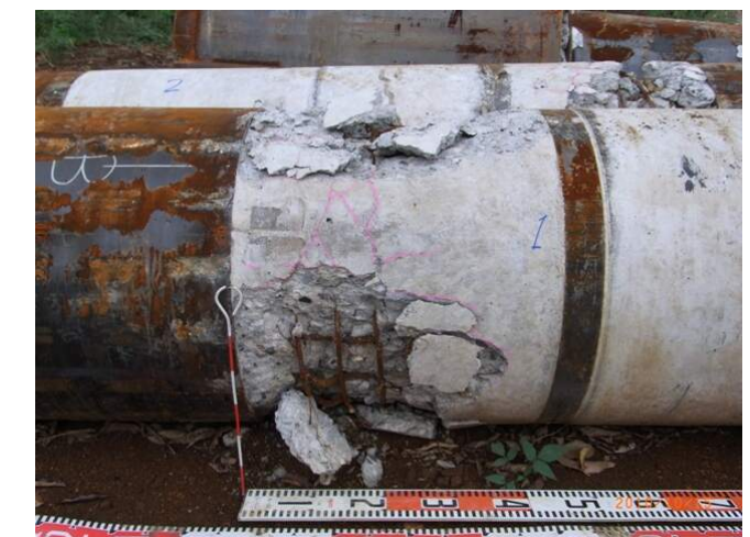
曲げ試験(試験後状況)
